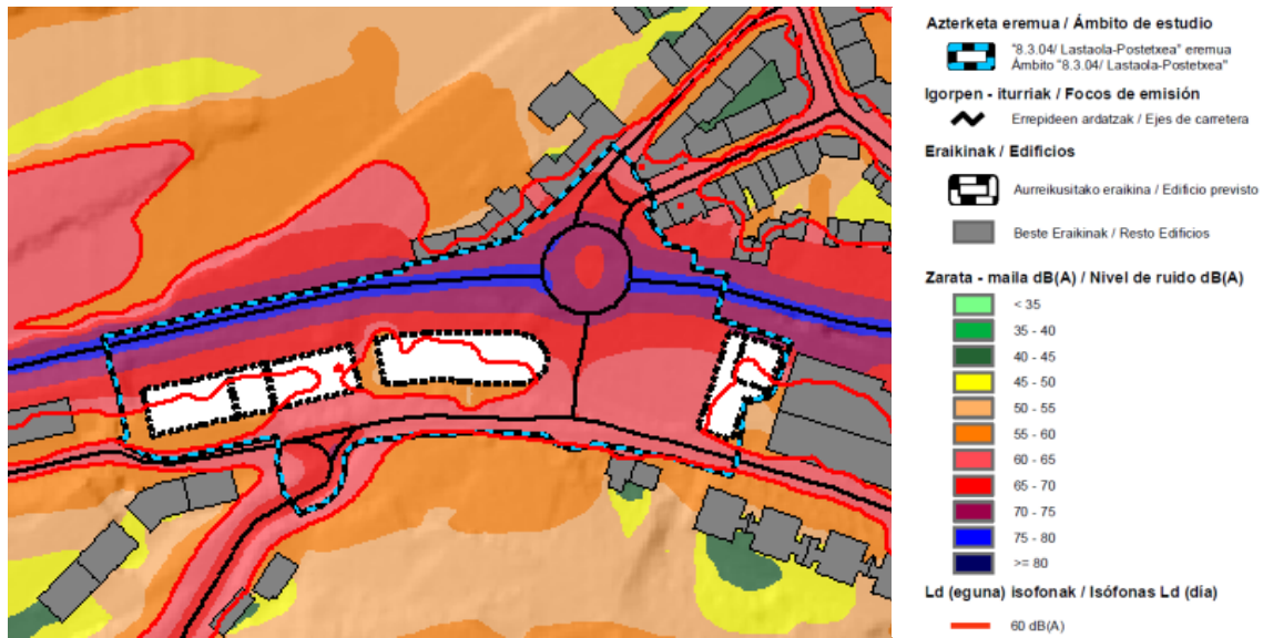
Imagen 36. Superficie afectada por la isófona de 60 dB (A) (línea roja, uso del suelo residencial) a 2 metros sobre el terreno, correspondiente al periodo tarde (Le).
