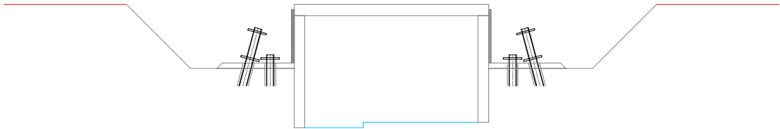
FASE 2º: - EJECUCIÓN DE MICROPILOTES. - PUESTA EN OBRA DE HORMIGÓN DE LIMPIEZA. - COLOCACIÓN DE JUNTA POREXPÁN.
