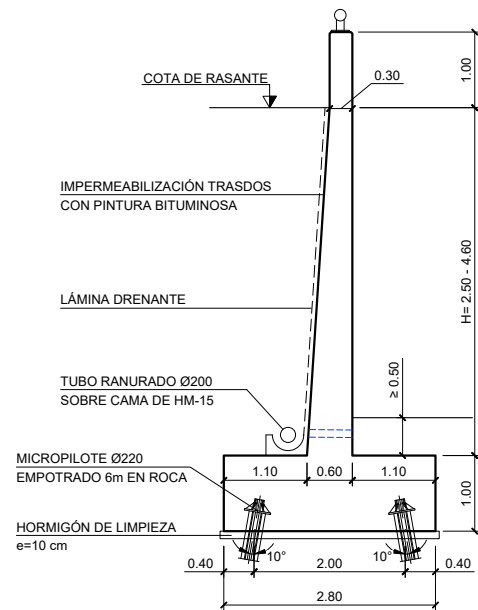
MURO TIPO 2. CIMENTACIÓN PROFUNDA ESCALA 1:50
