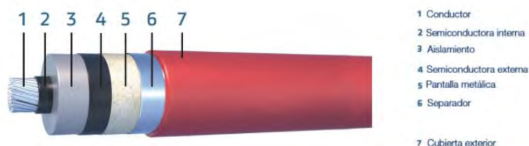
Figura 2. Detalle de cable de MT
