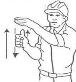
4 Levantar el aguilón o pluma lentamente
