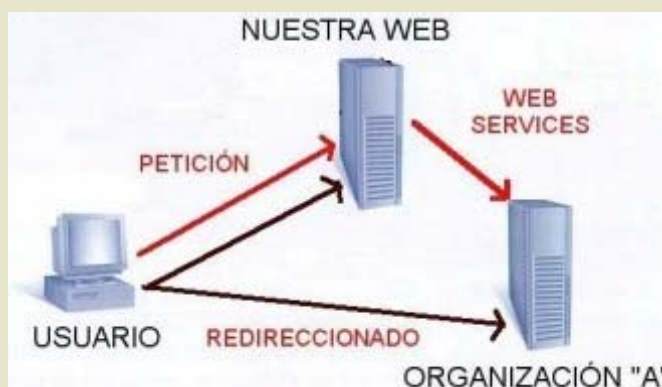
Gráfico: El Usuario que entra a nuestra web (donde ofrecemos información de viajes y meteorología), puede ser redireccionado desde nuestra web a la web de la organización «A» [flechas negras]; o bien nuestra web se pone en contacto (a través de Servicios Web) con el servidor de la organización «A». [ver flechas rojas]
