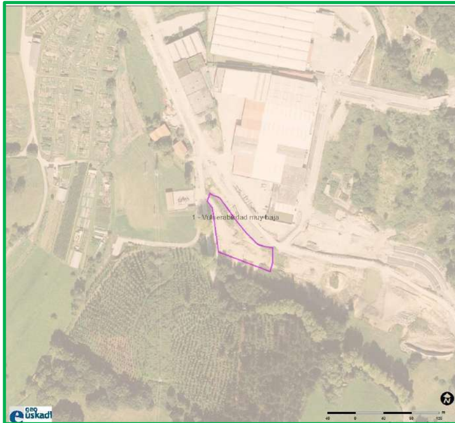
Figura 26. Imagen de vulnerabilidad de acuíferos de la zona de estudio (delimitada en rosa). Se observa que la zona de estudio queda englobada en un terreno con una vulnerabilidad de acuíferos muy baja. Fuente Visor GeoEuskadi.
