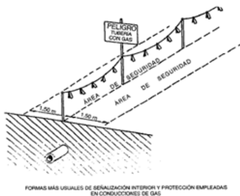
FORMAS MÁS USUALES DE SEÑALIZACIÓN INTERIOR Y PROTECCIÓN EMPLEADAS EN CONDUCCIONES DE GAS
