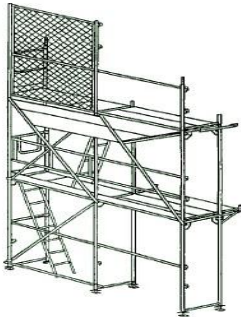
Andamio protegido mediante pantalla o módulo enrejado metálico
