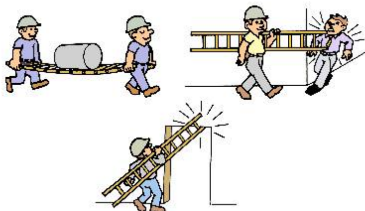
Formas incorrectas de transportar escaleras
