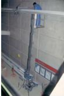
Plataforma elevadora vertical telescópica
