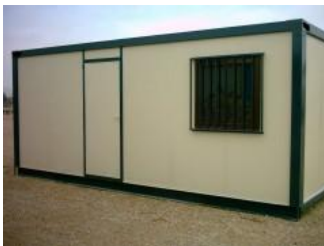
Imagen 2. Contenedor prefabricado para instalaciones provisionales de obra
