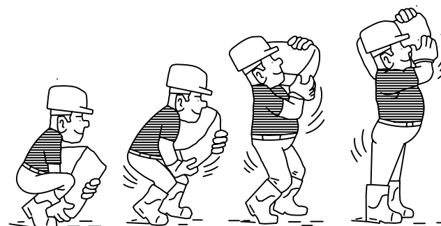
Izado correcto de cargas
