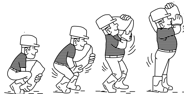
Izado correcto de cargas
