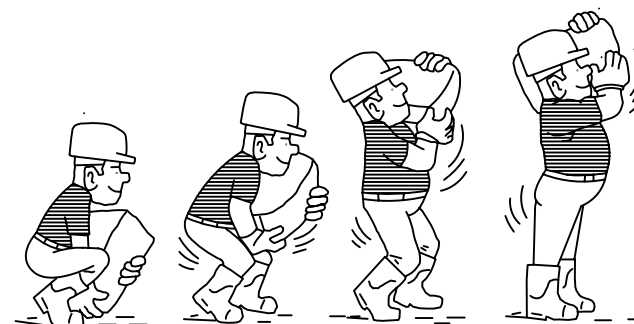
Izado correcto de cargas
