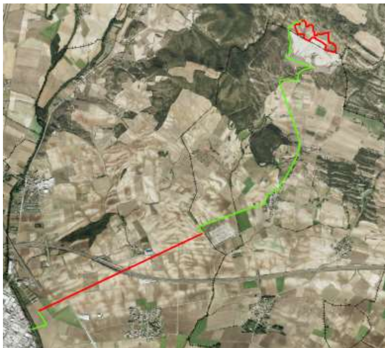
Figura. En verde se distingue el trazado de la línea en subterráneo y en rojo el tramo en aéreo
