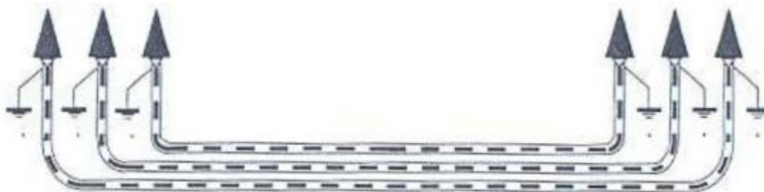
**Figura 27: Puesta a tierra de cubiertas metálicas.**
