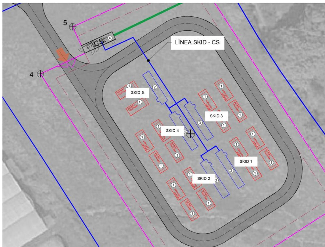
**Figura 24: Enumeración de Estaciones de potencia y cableado de MT**
