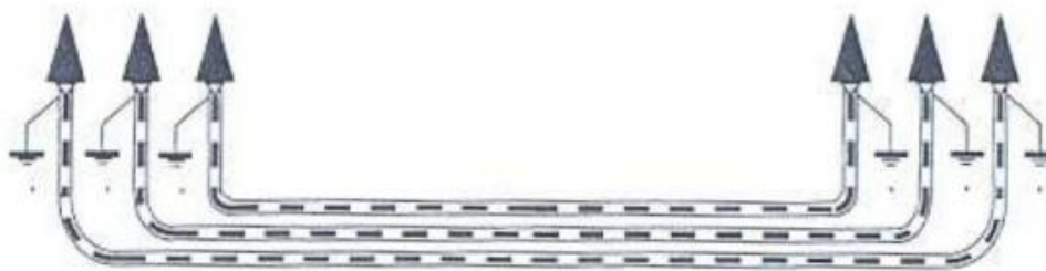
Figura 7: Puesta a tierra de cubiertas metálicas.
