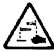
RIESGO DE CORROSION
