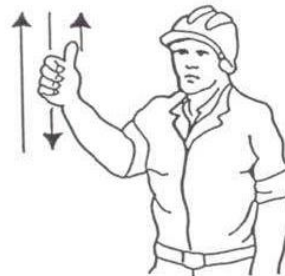
4 Levantar el aguilón o pluma lentamente
