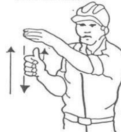
4 Levantar el aguilón o pluma lentamente
