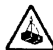
RIESGO DE CARGAS SUSPENDIDAS
