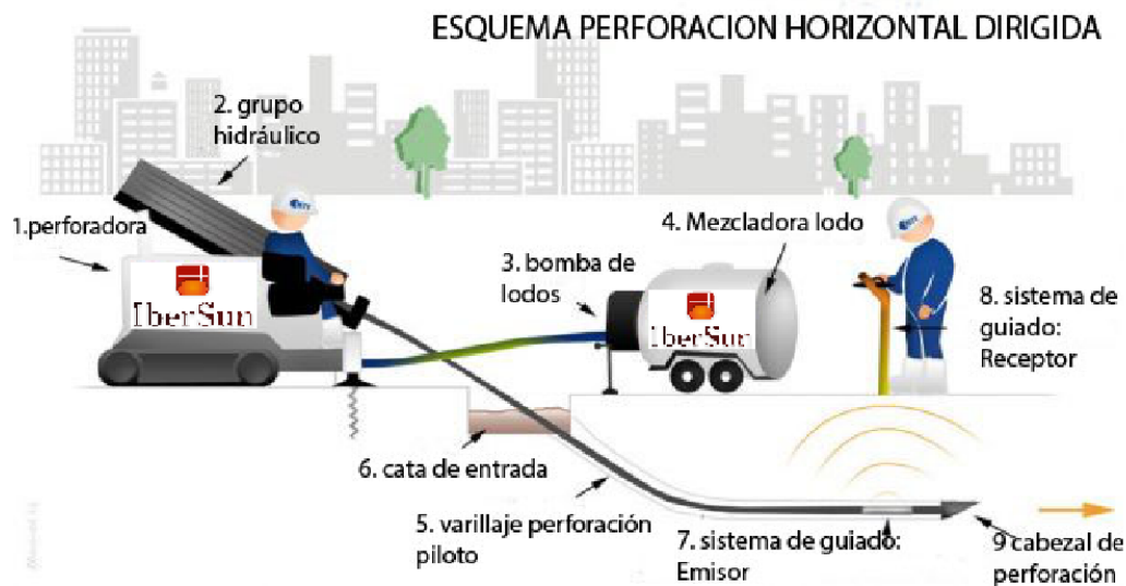
Ilustración. Esquema Perforación Horizontal Dirigida
