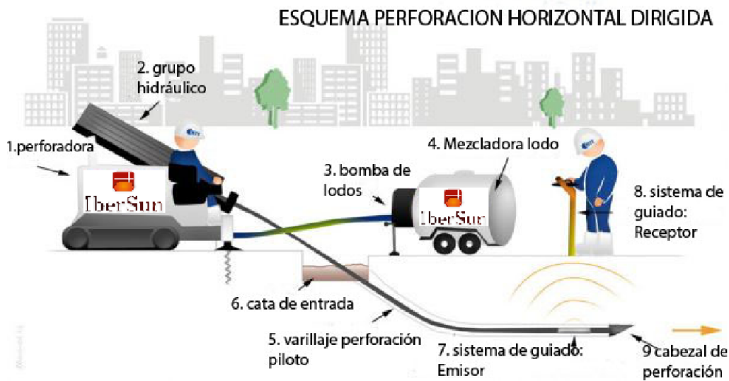
Ilustración. Esquema Perforación Horizontal Dirigida
