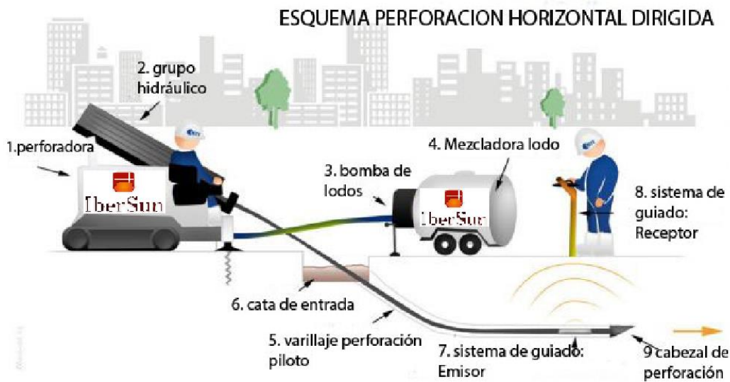
Ilustración. Esquema Perforación Horizontal Dirigida
