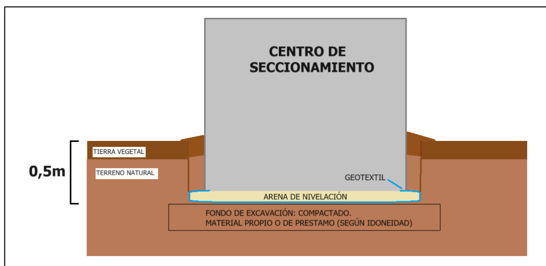
Esquema de instalación del centro de seccionamiento
