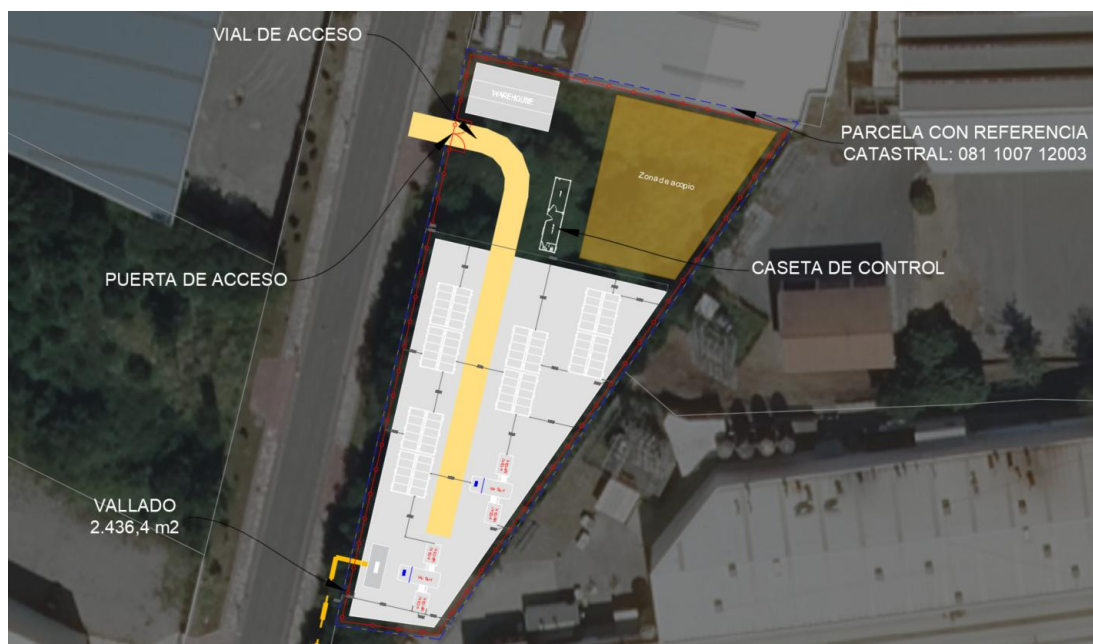
Implantación general Planta Almacenamiento
