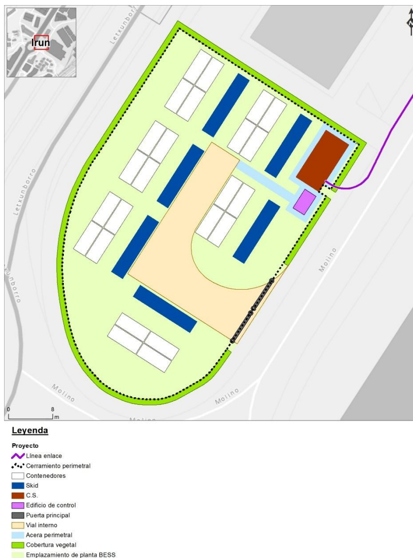
Figura 5. Detalle de implantación general Planta Almacenamiento.
