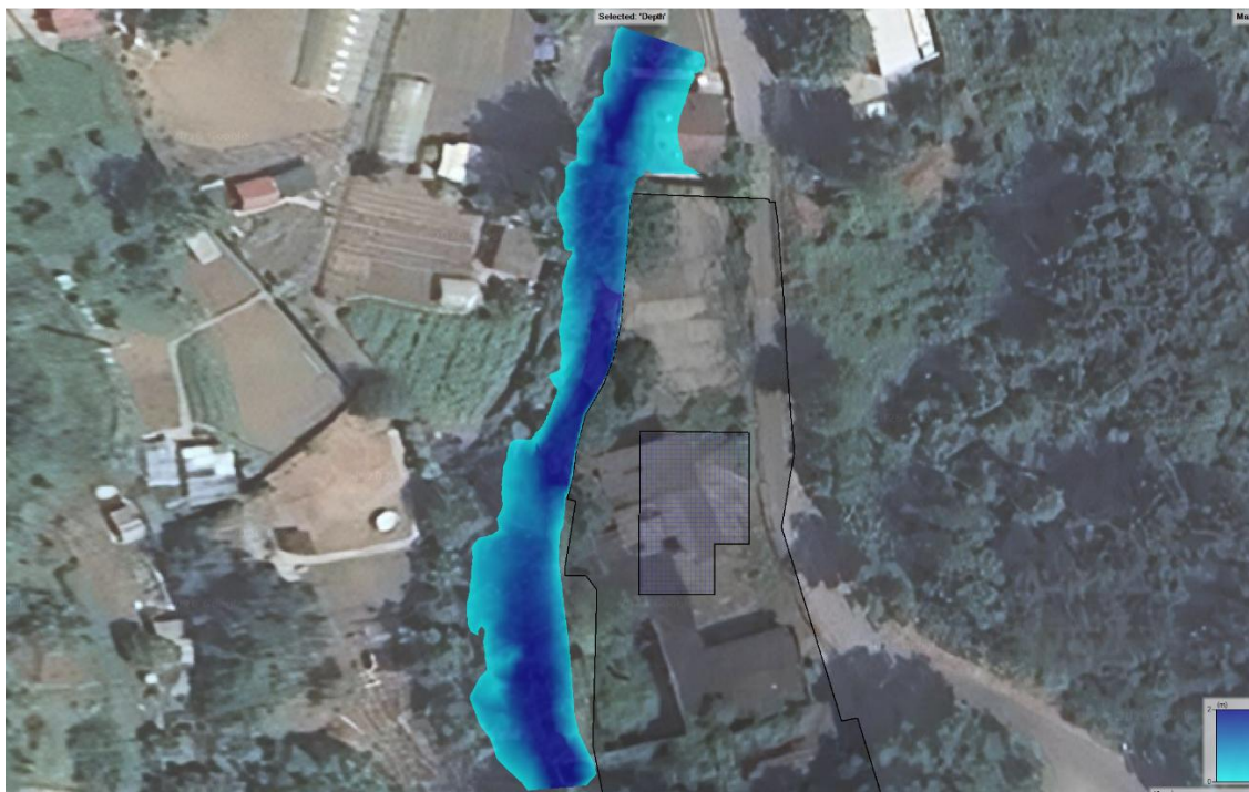
Figura 6.1.5.3. Extensión de la lámina de inundación para periodo de retorno de 500 años. Se comprueba que la inundación no alcanza el ámbito de implantación de la actuación.
