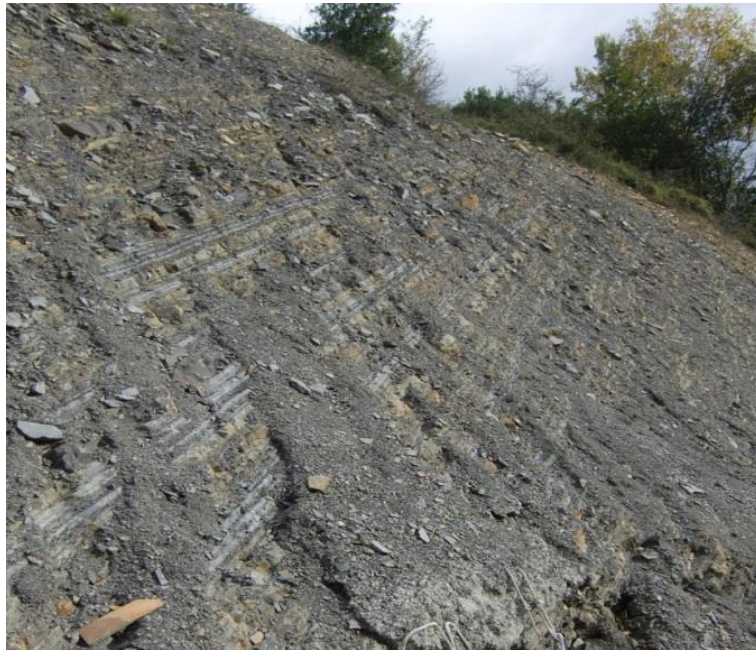
Fotografía nº1. Afloramiento flysch (litotipo FDC) ligeramente meteorizado GM II-III. Afloramiento, estación geomecánica EG-05/06/07 (Fuente: SENER 2011)
