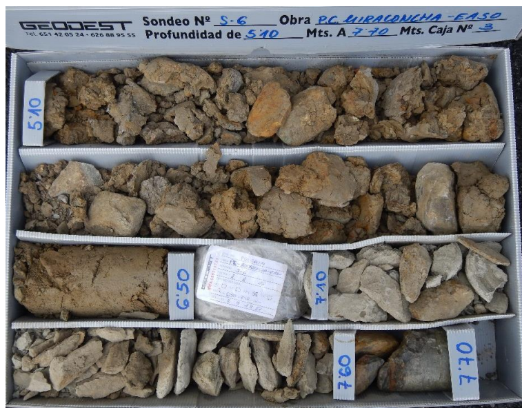
Fotografía nº6. Rellenos Antropogénicos (Q x ) hasta los 7,10 m, sobre el sustrato rocoso perforado en seco.
