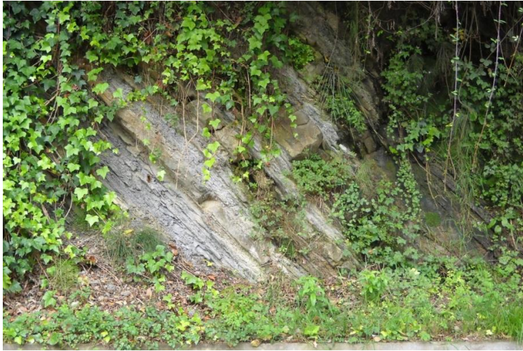
Fotografía n°2. Detalle flysch. Alternancia de margas y bancos cm de calcarenitas. Obsérvese el grado de meteorización de las margas (GM III-IV), frente al de los bancos más competentes de calcarenitas (aspecto más sano, GM I-II).
