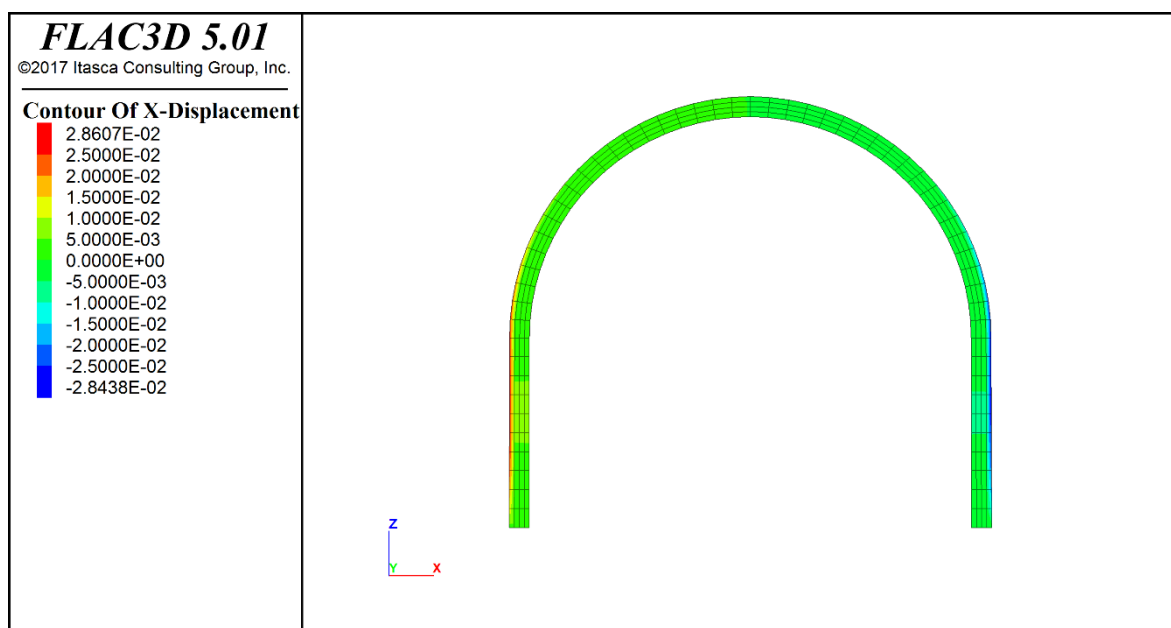
Ilustración 39 Desplazamientos horizontales sobre el sostenimiento G-III.
