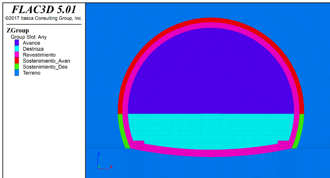
Ilustración 1. Sección de sostenimiento de análisis
