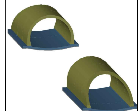
PERSPECTIVA FALSOS TUNELES
