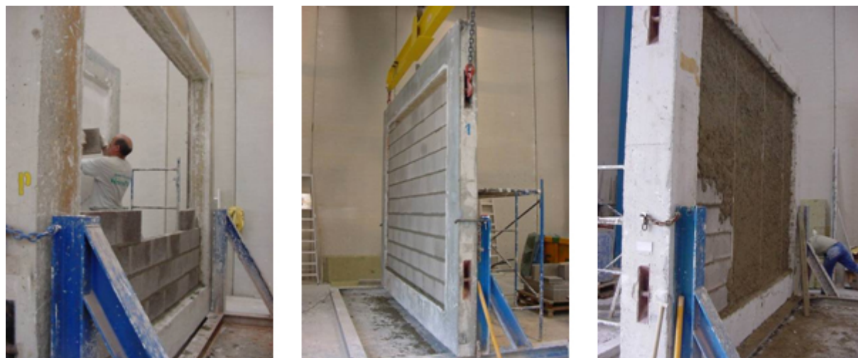
Figura 2. Momentos de la ejecución de una pared de bloque de picón en laboratorio.
