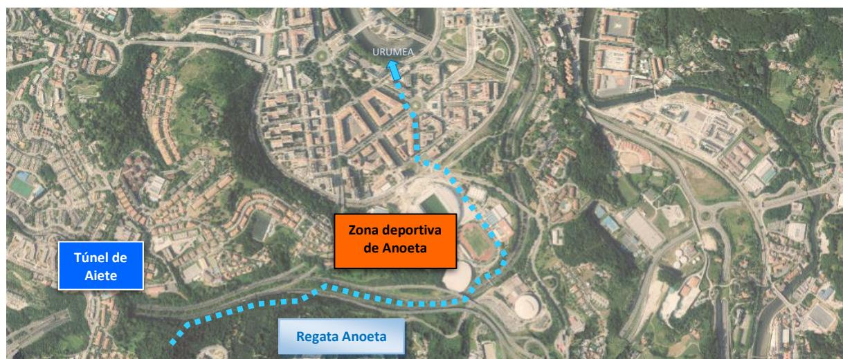
La regata Anoeta tiene su origen en las proximidades del túnel de Aiete de la Variante A-8 y desemboca en el Urumea aguas abajo del puente de Hierro, estando canalizada en todo su recorrido. Presenta tres tramos diferenciados: Aiete-Velódromo, Anoeta y Anoeta-Urumea.
