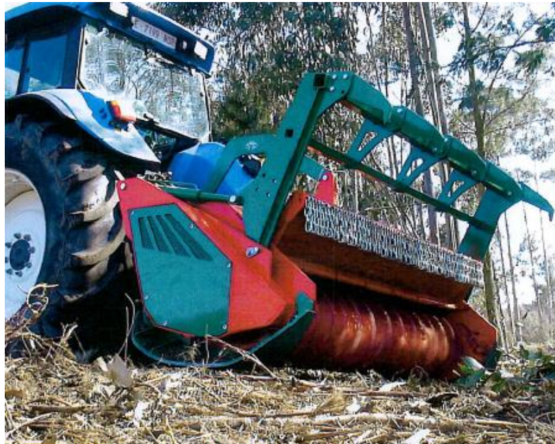
Tritadora forestal de martillos fijos implementada en tractor forestal llevando a cabo trabajos de desbroce.
