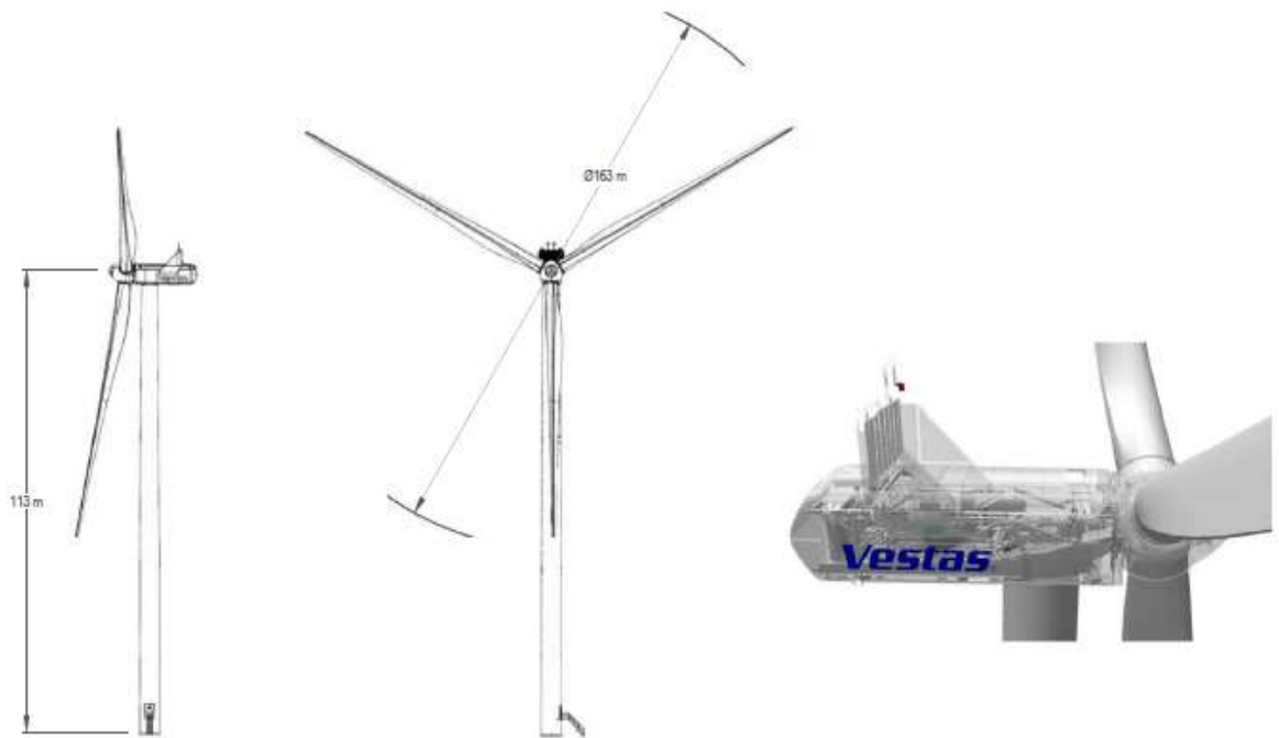
Figura III-4 Dimensiones del aerogenerador tipo Vestas V163-4.5 HH113 m.
