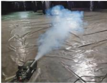
Figura 9. (a) Control de la eficacia del confinamiento mediante prueba de humos.
