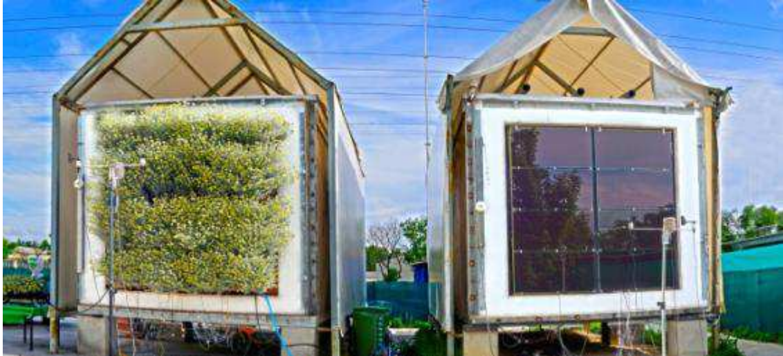
Figura 3: Celdas de ensayo PASLINK en el LCCE. De izquierda a derecha: celda ILARGI con una fachada vegetal, celda EGUZKI con una muestra fotovoltaica ventilada.
