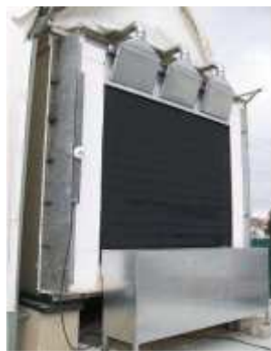
Figura 20 - Fachada con PCM's con movimiento de aire forzado
