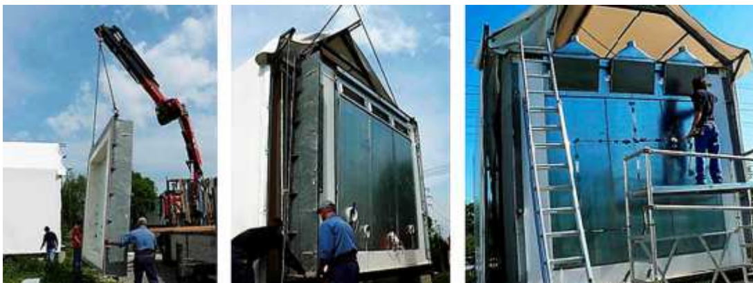
Figura 9 - Movimiento de la muestra e instalación en la celda de ensayos
