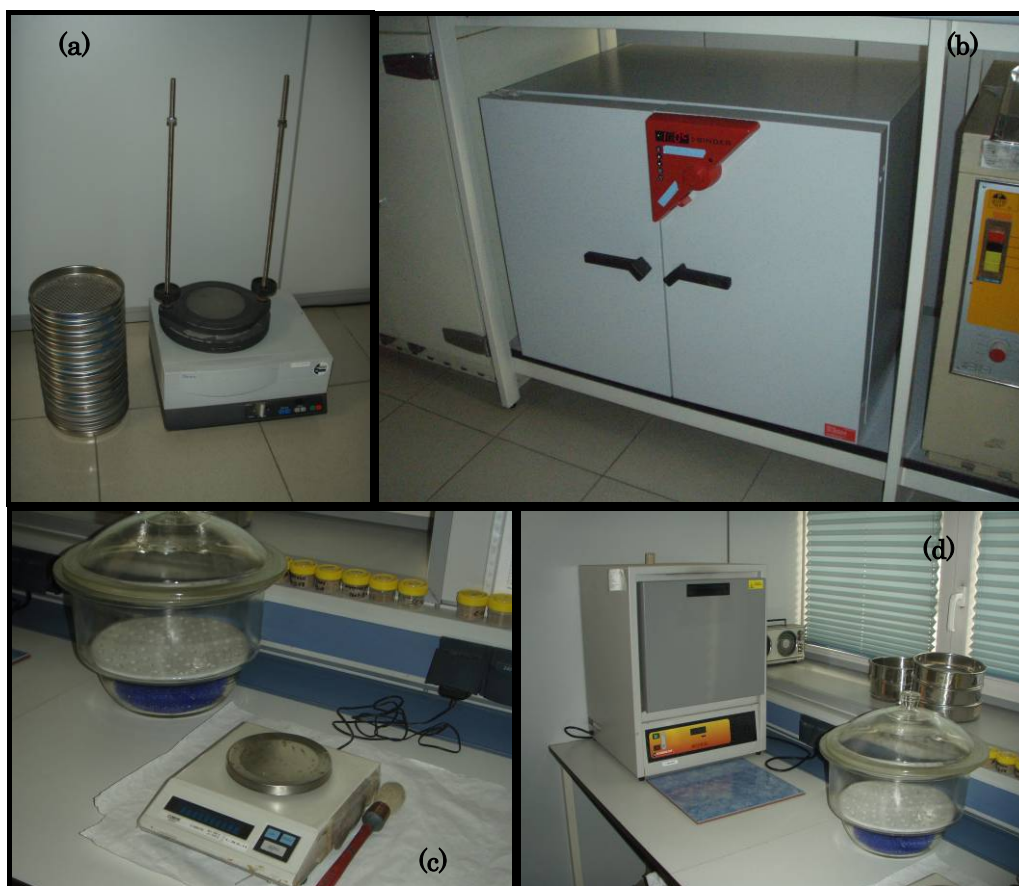
Figura 37. (a) Tamizadora, (b) estufa, (c) horno y (d) balanza empleadas en las distintas fases del análisis granulométrico y de la valoración de la materia orgánica del sedimento.
