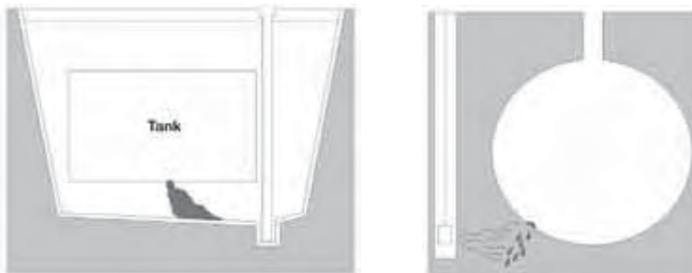
40. irudia: Ontzi baten barruko buzo-tutu kontzeptuaren eskema (ezkerraldean) eta lurpean lurrun organikoak detektatzeko gailuei buruzko eskema (eskuinaldean)
