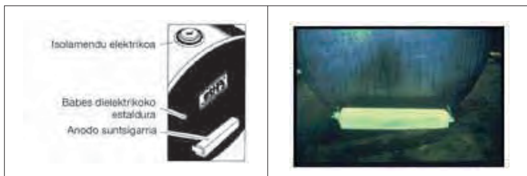
36. irudia: Babes katodikoa anodo suntsigarri bidez (irudia eta adibide erreal)
