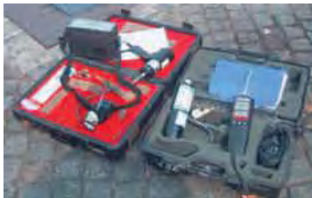
Konposatu organiko lurrunkorrak landan neurtzeko fotoionizatzaileak
