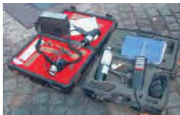
Fotoionizadores de campo para la medición de compuestos orgánicos volátiles
