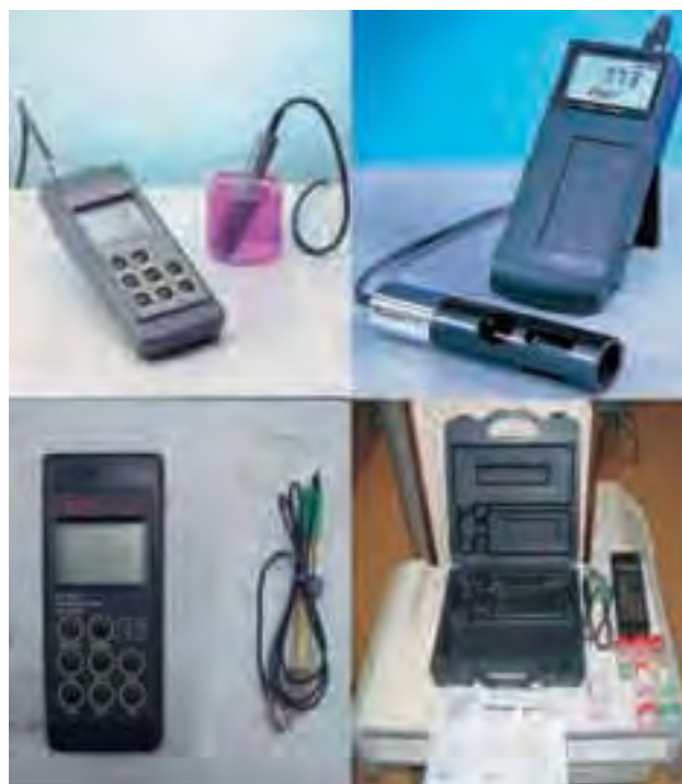
Diferentes equipos de medición de parámetros inestables: conductivímetro, oxígeno disuelto, ORP y kit completo de campo de medición
