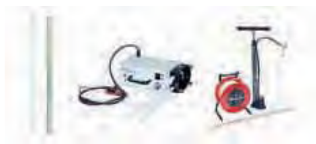
Distintos equipos de muestreo: tomamuestras desechables, bomba peristáltica y tomamuestras de niveles diferenciales
