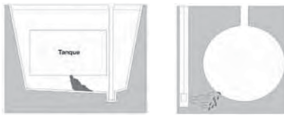
Figura 40: Esquema de los conceptos del tubo buzo dentro de un cubeto (izquierda) y la detección de vapores orgánicos en el subsuelo (derecha)
