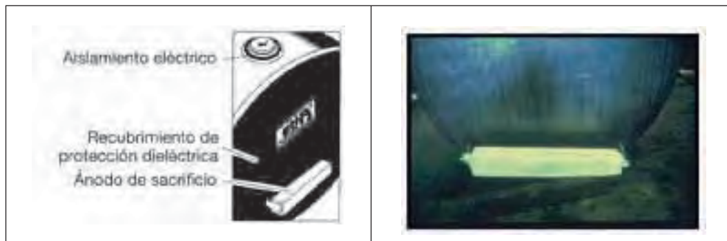
Figura 36: Protección catódica mediante ánodo de sacrificio (dibujo y ejemplo real)
