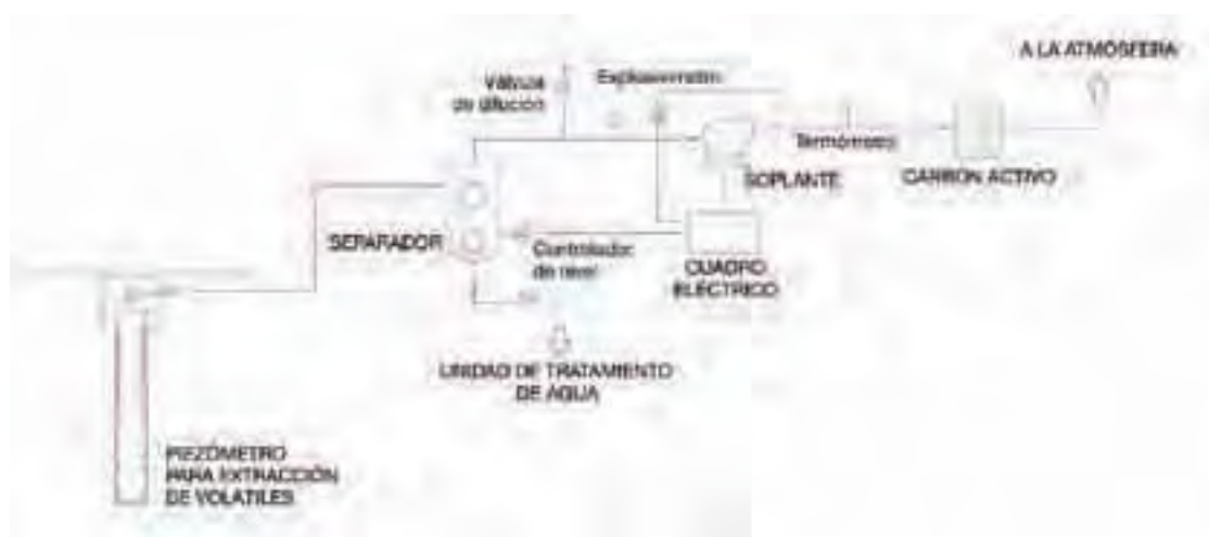
Ejemplo real de extracción de vapores por ventilación y tratamiento con carbón activo
