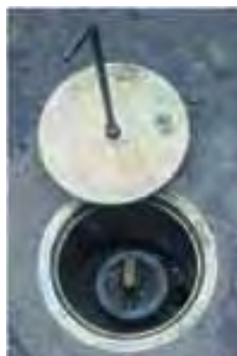
Ejemplo de esquema de piezómetro de control fotografía de la tapa de calle del mismo
