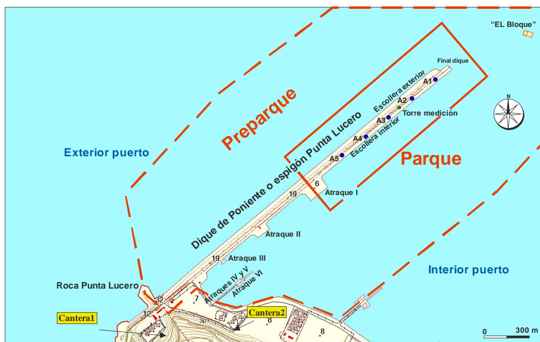
Figura 2. Localización del parque eólico en el dique de Punta Lucero del Puerto de Bilbao e identificación de algunos puntos relevantes en la zona. A1, A2... indica la ubicación de los aerogeneradores.
