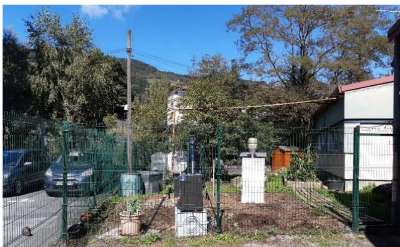
Figura 19.- Captadores PM 10 y PM 2,5 funcionando en paralelo durante 8 semanas.
