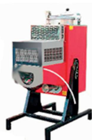
En los procesos de limpieza el disolvente se ensucia con restos de pintura, aceites y grasas. Siendo posible separar la suciedad mediante un proceso de destilación, en el que el disolvente sucio se pone en ebullición, de manera que el disolvente limpio se evapora, separándose de la suciedad y posteriormente se condensa para transformar el vapor en líquido y puede volver a ser reutilizado.
