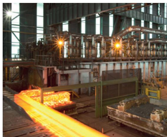
La laminación en caliente comprende la primera etapa del proceso de transformación de metales fundidos en productos acabados, un proceso mediante el cual se reduce el espesor del acero a las dimensiones adecuadas.
