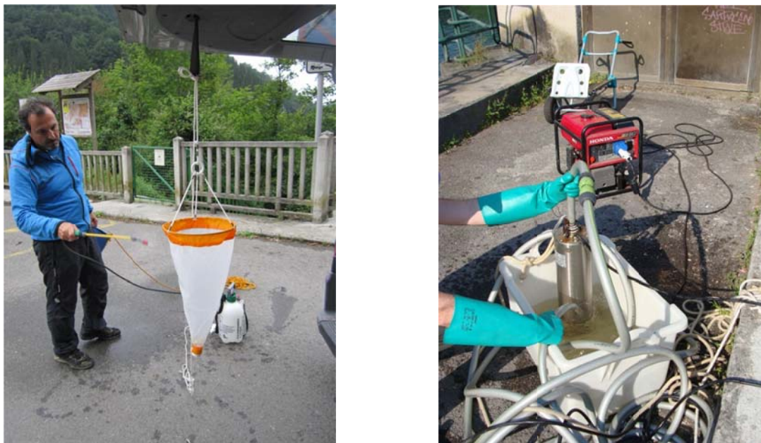
Figura 7. Imágenes de limpieza y desinfección del material de muestreo.
