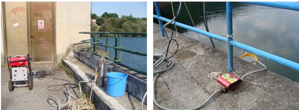
Figura 5. Imágenes de materiales y muestreo mediante bombeo hidráulico.
