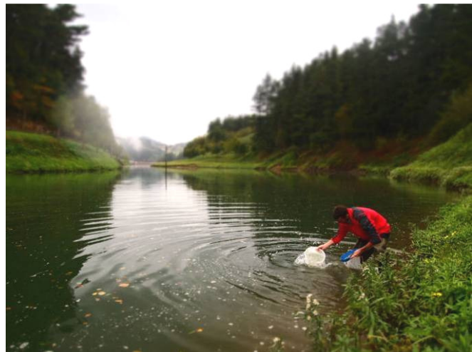
Figura 9. Tomando una muestra de agua discreta con la técnica de pozales. Embalse de Undurraga.
