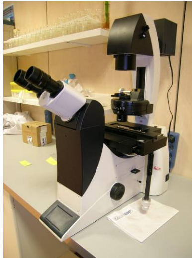
Figura 14. Microscopio invertido con filtros de polarización cruzada y cámara de sedimentación
