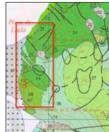
Foto 4: Mapa geológico donde se observa el tránsito lateral entre facies de plataforma (Caliza de Atxarre, nº 25 del EVE, 1:25.000) y talud (nº 25,24 del EVE, 1:25.000).
