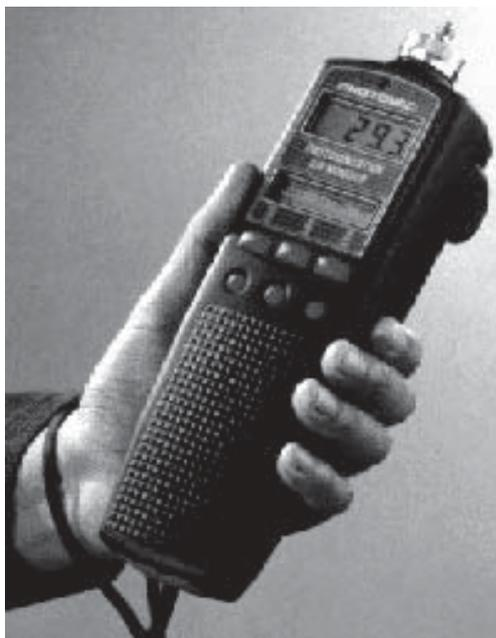
*Figura N° 59. Detector por fotoionización. Fuente: Catálogo Photovac International Incorporated*
