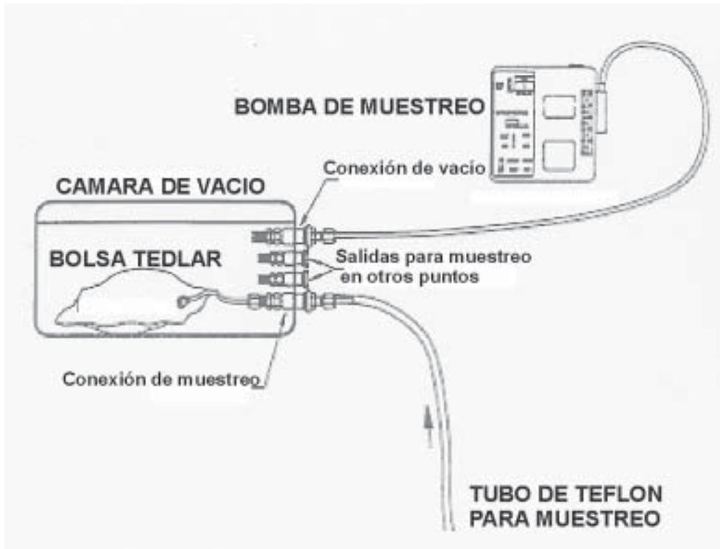
Figura N° 57. Muestreo mediante bomba de vacío y bolsa Tedlar. Fuente: EPA
