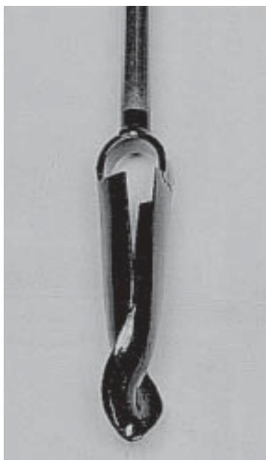
*Figura N° 2. Sonda «Edelman». Fuente: catálogo Eijelkamp*
