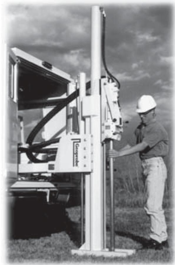
*Figura N° 56. Sonda Geoprobe. Fuente: Geoprobe Systems*
