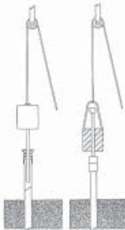
*Figura N° 15. Hinca mecánica de puntas coladoras (GIBSON Y SINGER, 1976)*
