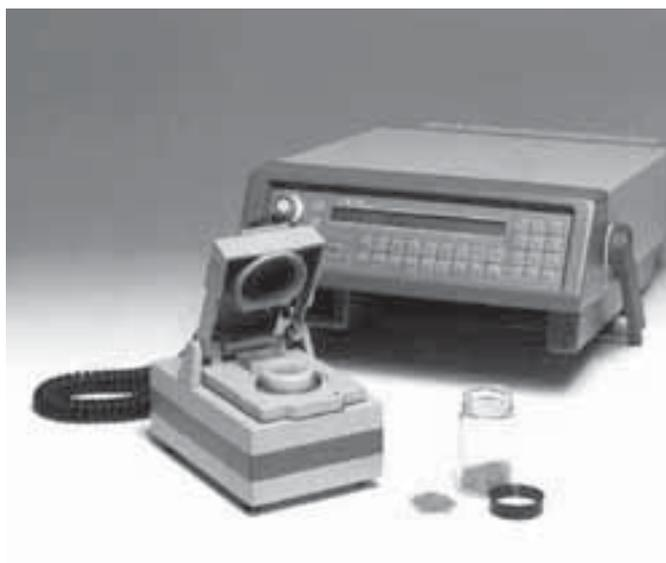
*Figura N° 58. Detector de metales por XRF*
