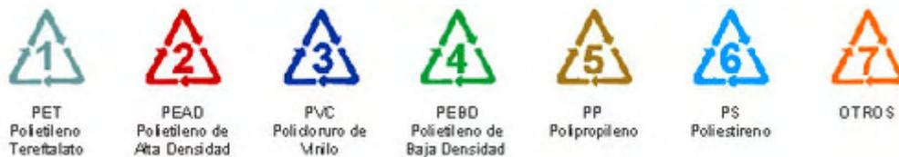
Marcar las piezas de plástico de los productos de mobiliario urbano con su código de identificación de materias primas facilita al consumidor y/o al gestor de residuos la identificación del material. Dicha identificación es el primer paso para una separación eficaz del material y su desviación de la corriente de residuos destinados a vertedero o incineración, y así poder destinarlo a reciclaje.
