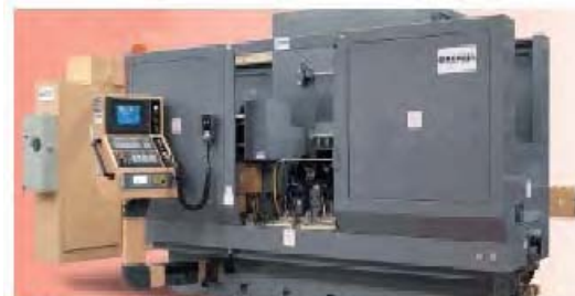
Máquina después del retrofiting
