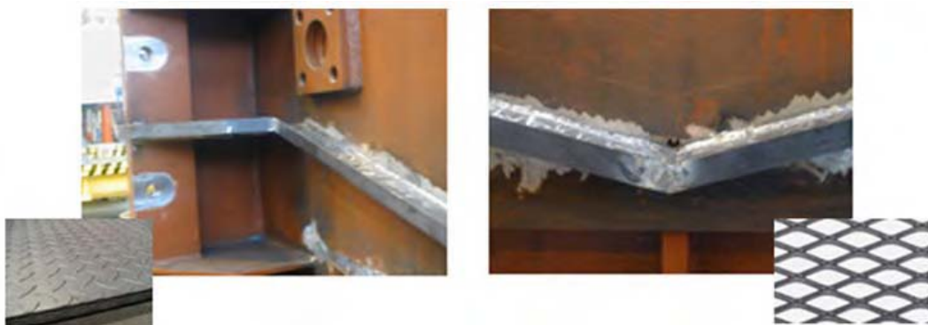
Canaletas soldadas al cabezal y chapa ranurada o con relieve para evitar deslizamientos a causa del aceite Fuente: Fagor Arrasate
