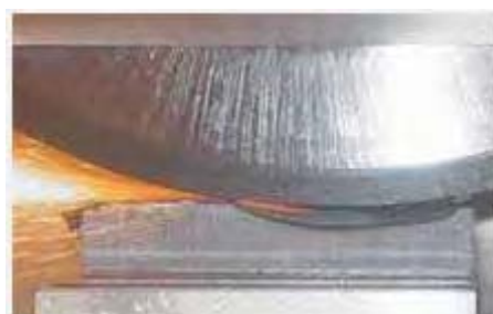
Grind hardening con refrigeración en pieza
