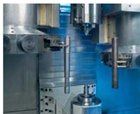
Torretas de carga/ descarga de pieza
