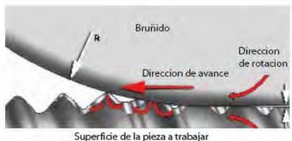
Acción el rodillo sobre la superficie a trabajar Fuente: Catálogo comercial Ecoroll
