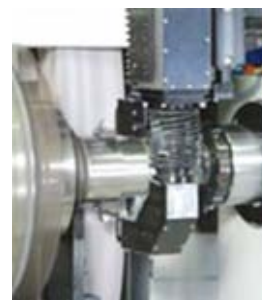
Medidor multidiametro que permite medir la pieza sin parar el proceso.
