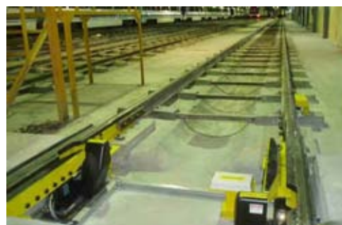
Equipo de medida de geometría de rueda con posibilidad de conectar a un torno de foso.
