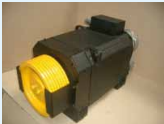
Igogailuaren motor elektrikoa
