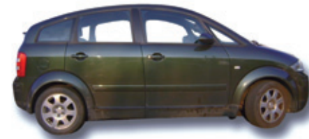
Audi A2 aluminiozko xasis kroskobakarrarekin (Robotiker Tecnaliak utzitako argazkia)
