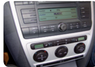
▲ Bi pantailako ibilgailua: bata klimatizatorako eta bestea multimedia-sistemarako (Robotiker Tecnaliak utzitako argazkia).
