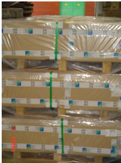
Figura 10. Vista a detalle de bultos con el nuevo sistema de envase y embalaje que incorpora fleje de PET.
